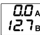
Диапазон измерения вольтметра: 8,5-32 В, точность  $\pm 0,1$  В
