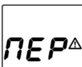
При неправильном подключении ЗУ отключается от аккумулятора, на экране замигают надпись “ПЕР” и значок тревоги. После отсоединения клемм ЗУ от аккумулятора работоспособность ЗУ автоматически восстанавливается.
