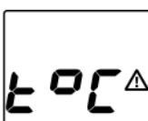
На экране замигают надпись “ $t^{\circ}\text{C}$ ” и значок тревоги. После уменьшения внутренней температуры источник вернется к обычному функционированию.
