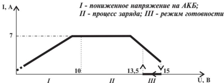
При необходимости АКБ может быть установлена на автомобиль. Однако для набора **100%** емкости необходимо дать ЗУ поработать в режиме периодического отключения. В зависимости от технического состояния АКБ и ее возраста для этого может потребоваться от получаса до нескольких часов. В таком режиме ЗУ и АКБ могут находиться неограниченно долго без вреда для АКБ, более того, старая «подсевшая» АКБ может восстановить свои характеристики.
