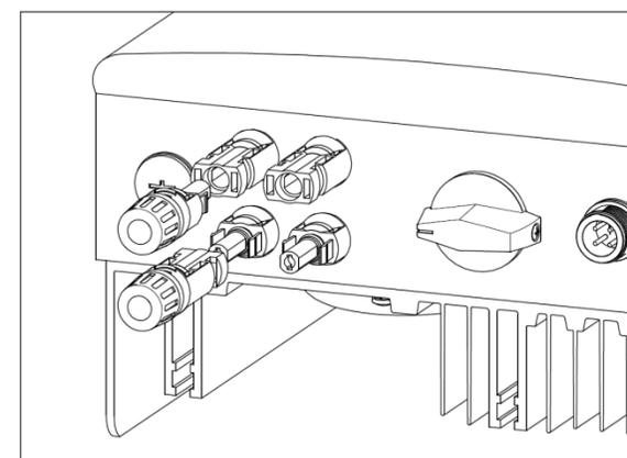
Рисунок 4.11 – Подключите DC коннекторы к инвертору
