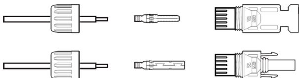
Рисунок 4.8 – Открутите герметизирующую крышку с коннектора
