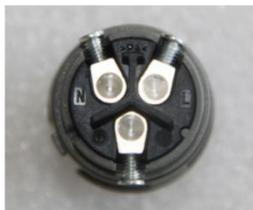
Рисунок 4.13 – Маркировка контактов AC терминала
