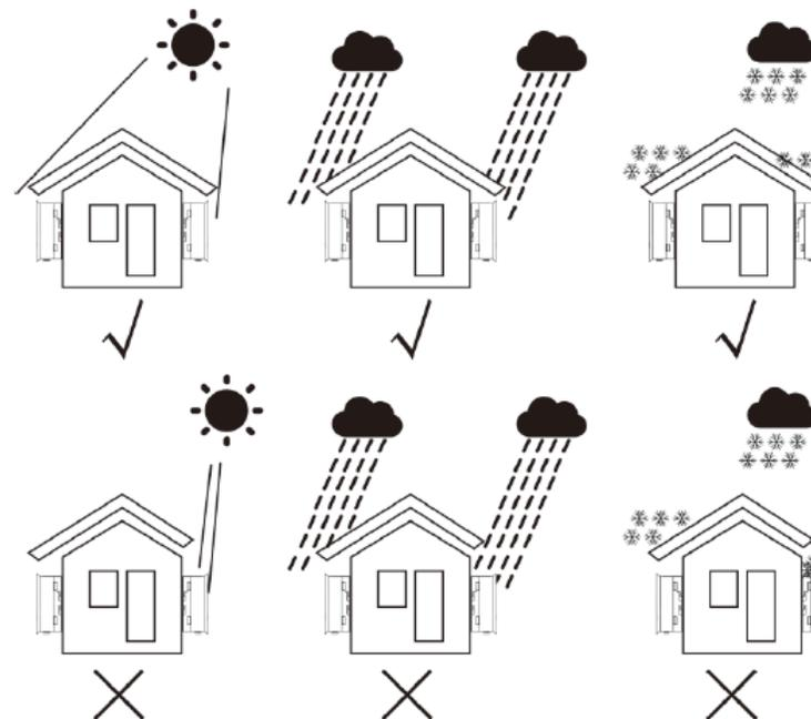
Рисунок 4.1 – Расположение инвертора
