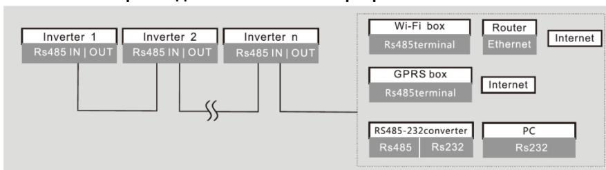
Рисунок 5.23 – Система мониторинга
