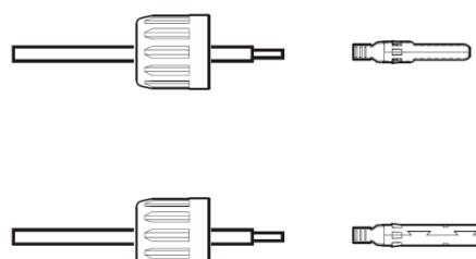
Рисунок 5.13 – Соединение кабеля, герметизирующей гайки и контактного штыря
