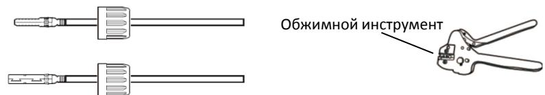
Рисунок 5.14 – Обжим контактного штыря и кабеля
