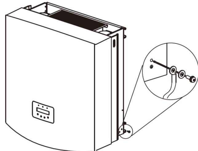
Рисунок 5.9 – Подсоединение кабеля
