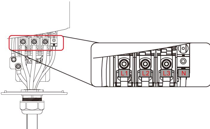
Рисунок 5.206 – Подсоединение кабеля к терминалу переменного тока
