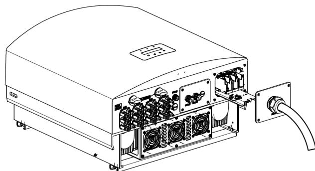
Рисунок 5.20а – Подсоединение кабеля к терминалу переменного тока
