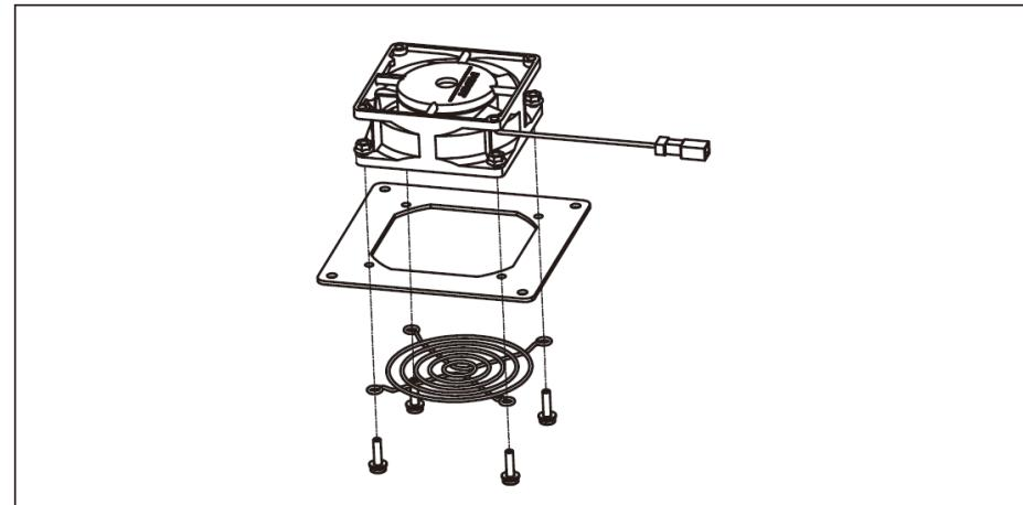
7. Подключите провода, установите вентилятор в инвертор. Перезапустите инвертор.
