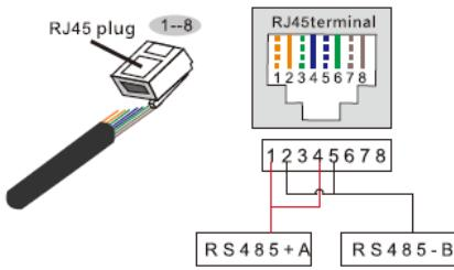
Рисунок 5.29 – Подключение RJ45
