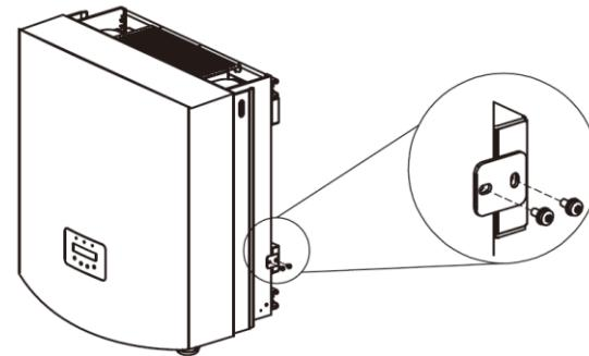
Рисунок 5.6 – Фиксация инвертора
