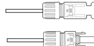
Рисунок 5.15 – Коннектор с закрученной герметизирующей гайкой
