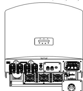
Рисунок 5.19 – Отсоединение крышки терминала разъемов переменного тока
