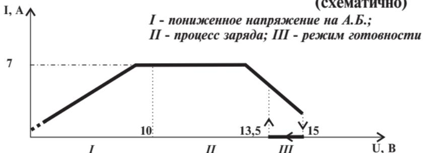
**46. Заряд АКБ в неавтоматическом режиме током, установленным ручкой регулировки.** ЗУ работает в режиме генератора стабильного тока, поэтому во время заряда **необходимо контролировать степень заряженности АКБ вручную** общепринятыми методами (по напряжению, по времени и силе тока, по плотности электролита и т.д.).
